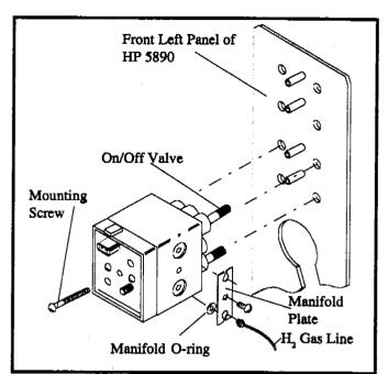
Figure 3.4. Gas Flow Module
